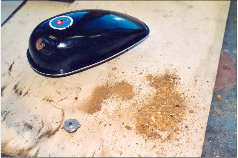
Kuva 6 Mopon bensini tankista löytynyttä ruostetta
