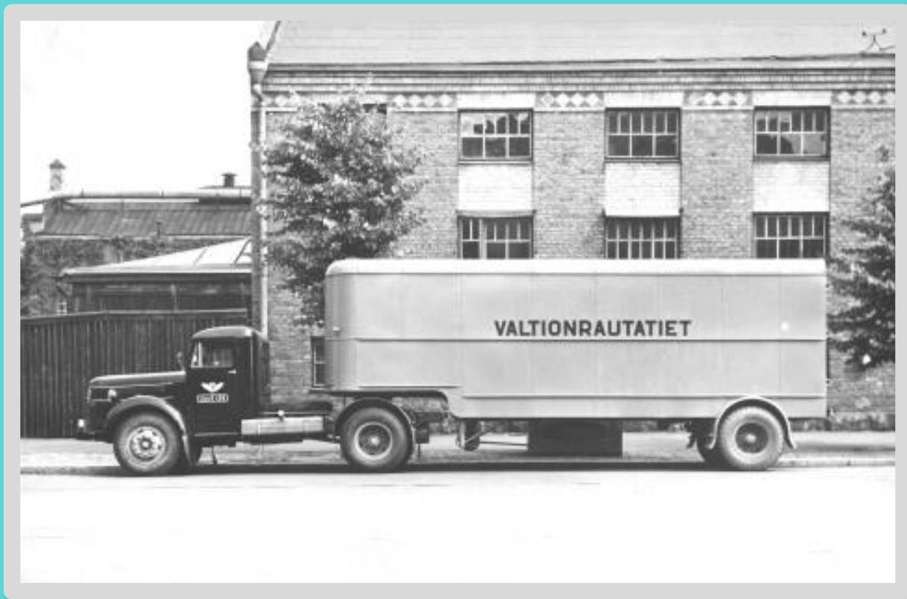
VR:n Volvo L 246 -kuorma-auto, perässään DAF:n valmistama puoliperävaunu. Vuosimalli 1951. Kuva Suomen Rautatiemuseo CC BY-NC-SA 4.0.
